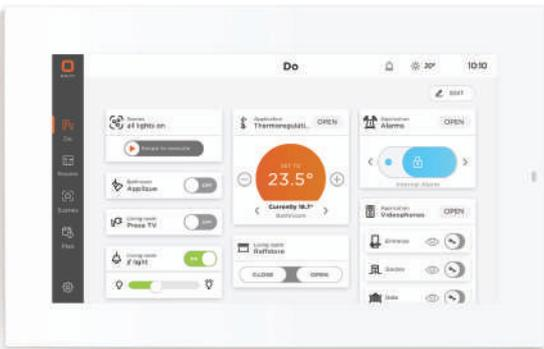
Supervisione bidirezionale di tutte le funzioni dell'impianto: illuminazione, termoregolazione, motorizzazione, allarmi, videosorveglianza, multimedia, videocitofoni, impianto fotovoltaico, contatori di energia e consumi, controllo degli accessi, sistema antincendio, ecc.
